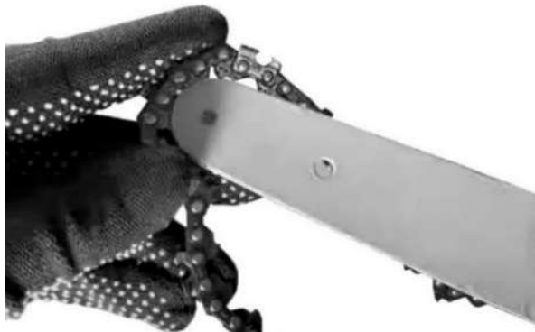
Рисунок 7. Уведення ланцюга в зачеплення з веденою зірочкою на напрямній шині.
