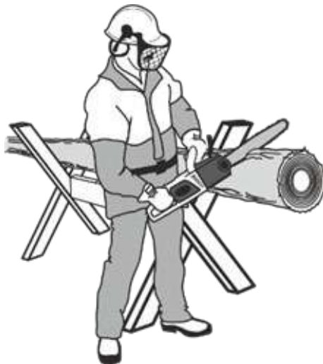
Рисунок 13. Схема розпилу колоди з використанням козлових опор.
