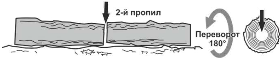
Рисунок 12. Схема остаточного розпилу колоди з протилежного боку.
