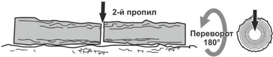
Рисунок 12. Схема остаточного розпилу колоди з протилежного боку.
