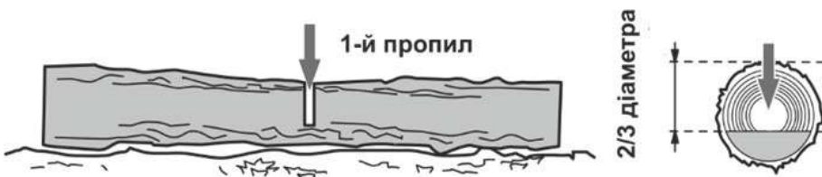
Рисунок 11. Схема попереднього розпилу колоди.
