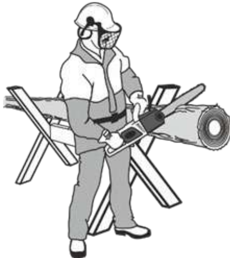
Рисунок 13. Схема розпилу колоди з використанням козлових опор.
