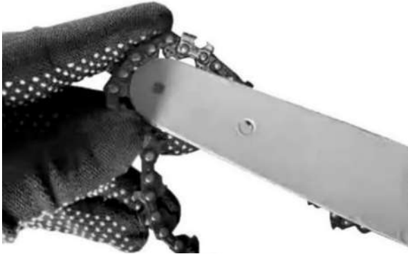
Рисунок 7. Уведення ланцюга в зачеплення з веденою зірочкою на напрямній шині.
