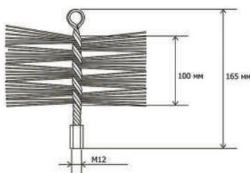
Щітка металева для чистення димоходу Savent легко видаляє сажу та інші відкладення зі стінок димохідних труб та теплообмінників, таким чином відновлюючи необхідну тягу для ефективної роботи котла. Щітка виготовлена з вуглецевої сталі, має високу якість і міцну гнучку конструкцію, що дозволяє ефективно проводити чистку
