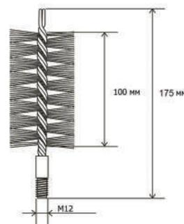
Під час роботи твердопаливних котлів, камінів і печей на поверхні стінок камери згоряння і на теплообміннику утворюються сажа, смоли та інші відкладення. Це призводить до зменшення ККД і збільшення витрати палива.
