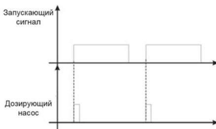
**B. Циклическое дозирование:** насос работает постоянным циклом пока присутствует запускающий сигнал.
