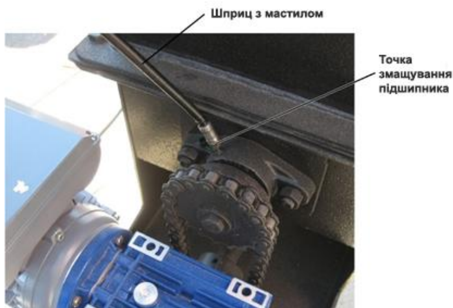
Малюнок 9 - Матило підшипників шнекової подачі.
