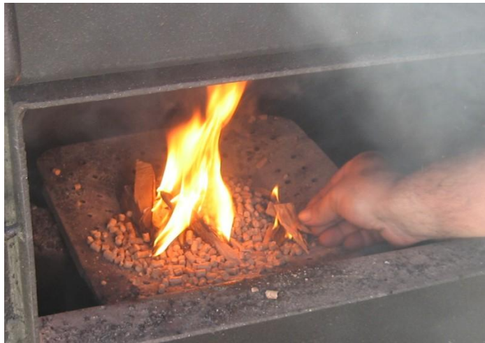
Малюнок 8 - Ручне розпалювання палива в котлах версії RK3G/S
