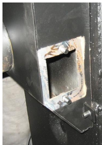
Малюнок 11 - Отвір для чищення адаптера диму
