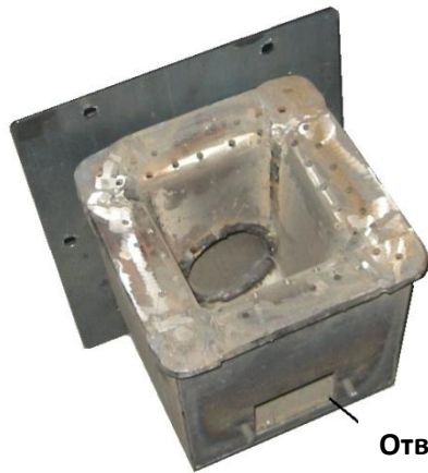
Малюнок 12 - Отвір для чищення пальника.
