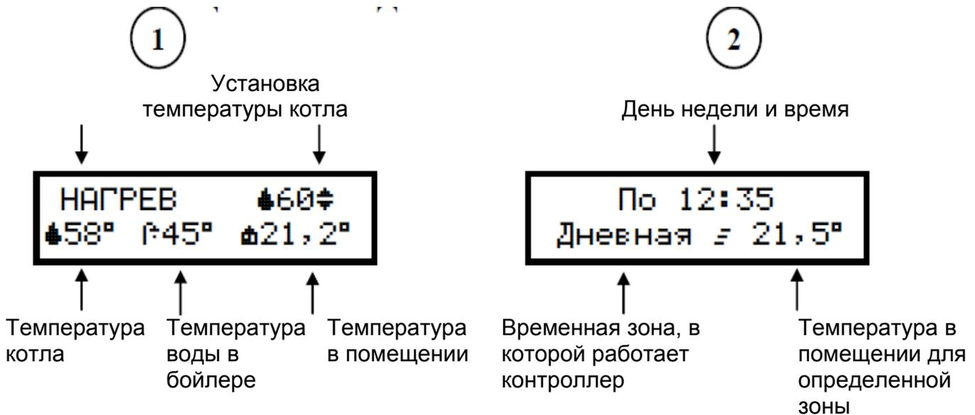
Информация на цифровом дисплее изменяется циклично. Первоначально отображается информация ① - можно кнопками или изменить установленную температуру котла.
