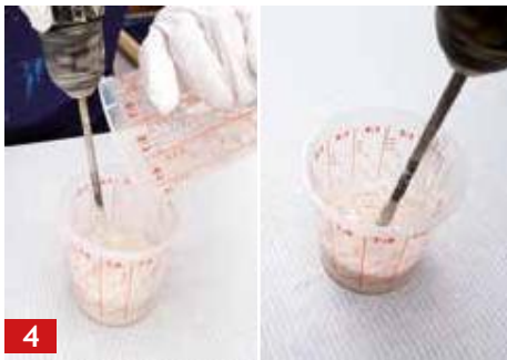
4 Обережно додайте порошок A1 до смоли A1. Перемішуйте міксером, доки всі грудочки не зникнуть ( \pm 1 хв.), що дасть гладкий матеріал
