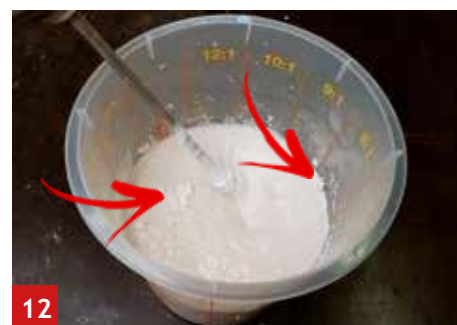
12 Використовуйте міксер, доки всі грудочки не зникнуть (± 1 хв.), що призведе до отримання гладкого матеріалу
