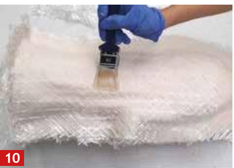
10 Нанесіть ще один шар A1. Повторіть доки 4 шари Тривісного волокна A1 не будуть сформовані
