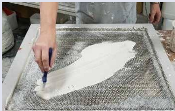
Для ламінування потрібно працювати «вологим по вологому». Швидкий спосіб нанесення A1 — пензлем або валиком.
