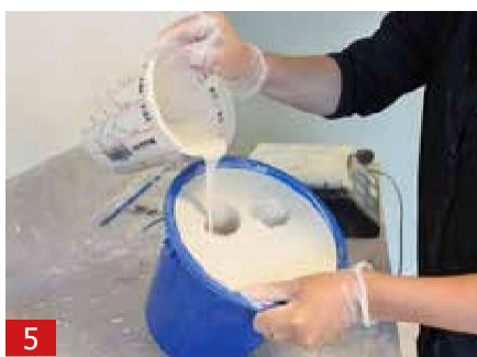
5 Повільно влийте трохи A1 уздовж краю в отвір. Нехай A1 протікає в усіх напрямках, щоб зменшити захоплення повітря. Поверніть/переверніть і постукайте по відру, щоб A1 належним чином заповнив порожнини й не утворилися бульбашки повітря. Потім влийте решту A1. Знову постукайте по відру та заповніть A1 доверху
