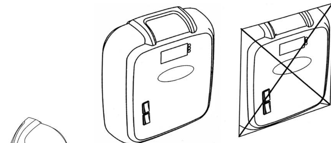
Рисунок 4. Пульт управления нельзя утапливать в стену.
