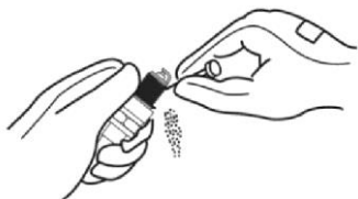
а) Викрутіть свічку запалювання б) Видаліть нагар
