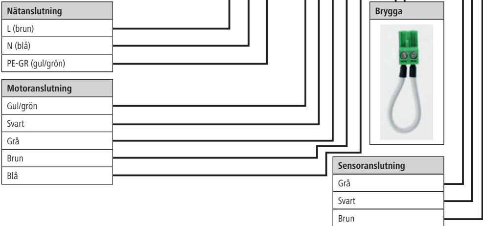
Bild 8: Kopplingsschema för kretskortet med kondensator - MaxiSwing
