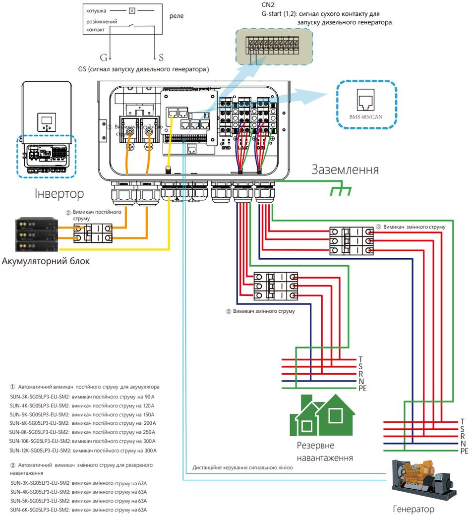
① Автоматичний вимикач постійного струму для акумулятора
