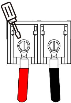
Для моделей 3-12 кВт, звичайний розмір з'єднувального гвинта: M10
