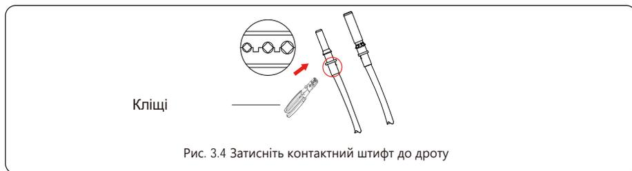
в) Вставте контактний штифт у верхню частину роз'єму і закрутіть накидну гайку до верхньої частини роз'єму. (як показано на малюнку 3.5).
