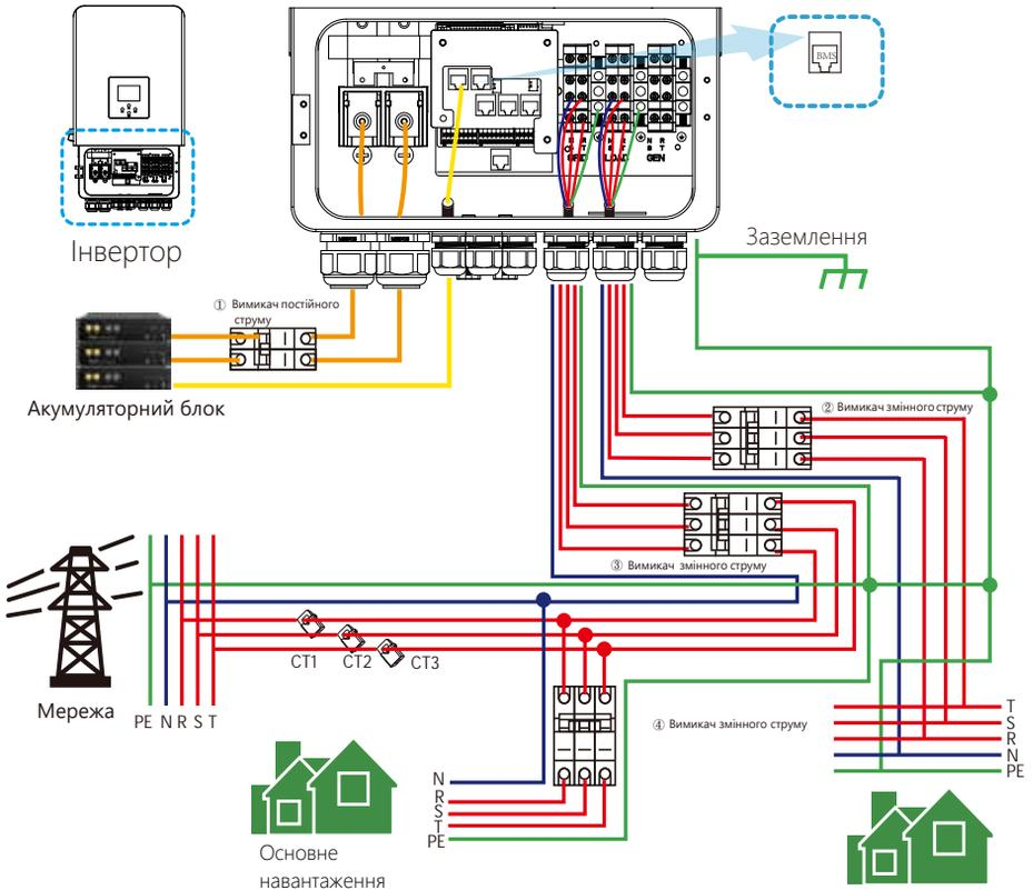
① Автоматичний вимикач постійного струму для акумулятора
