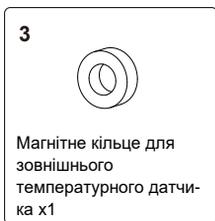
3 Магнітне кільце для зовнішнього температурного датчика x1
