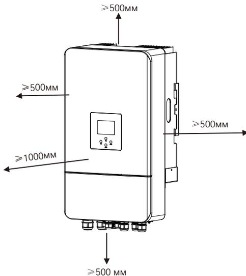
Для належної циркуляції повітря та розсіювання тепла залиште вільний простір приблизно 50 см збоку та приблизно 50 см зверху та знизу від приладу. І 100 см спереду.
