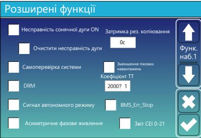
**Несправність сонячної дуги ON:** функція тільки для США.
