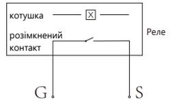
GV/GS (сигнал запуску дизельного генератора)
