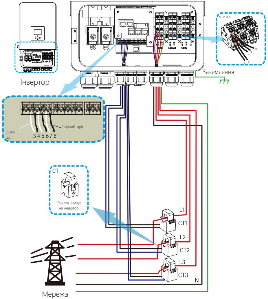
\*Примітка: якщо показники потужності навантаження на LCD-дисплеї неправильні, будь ласка, змініть напрямок стрілки КТ на протилежний.
