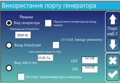
**Номинальна потужність на вході генератора:** дозволена максимальна потужність від дизельного генератора.
