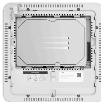
5. Опустіть фіксатор жорсткого диска.
