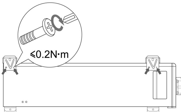
3) Stapeln Sie die Batterien übereinander und befestigen Sie sie mit 4 Schrauben (M4×12). Die Anzahl der gestapelten Batterien darf 6 nicht überschreiten.
