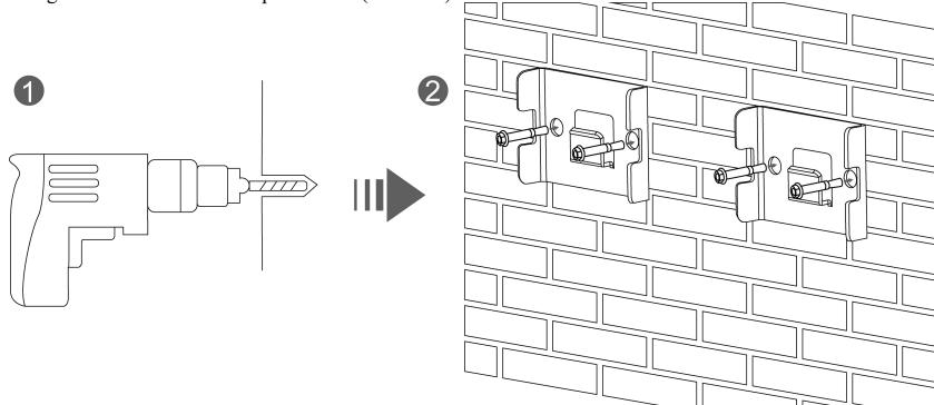
4) Heben Sie die Batterie an und hängen Sie sie an die Haken, wobei alle Halterungen auf der Rückseite der Batterie sicher an den Haken an der Wand befestigt sein müssen. Sichern mit zwei Schrauben (M4 \* 12).
