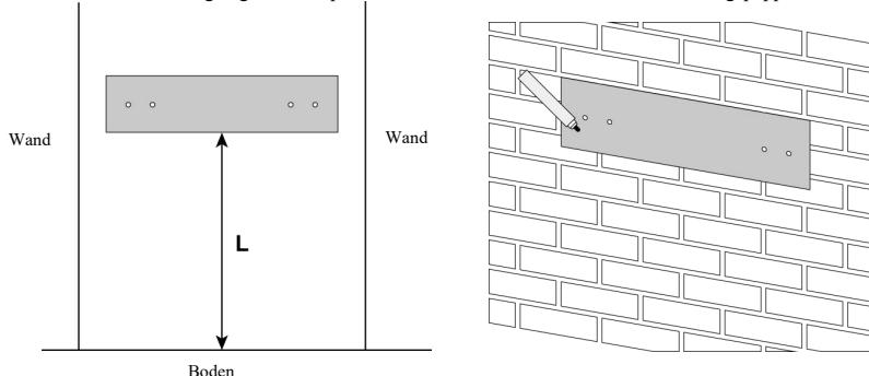
Die Unterscheidung zwischen Bodenmontage und Wandmontage erfolgt anhand des **Abstands L** zwischen dem Boden und der Positionierungsschablone.
