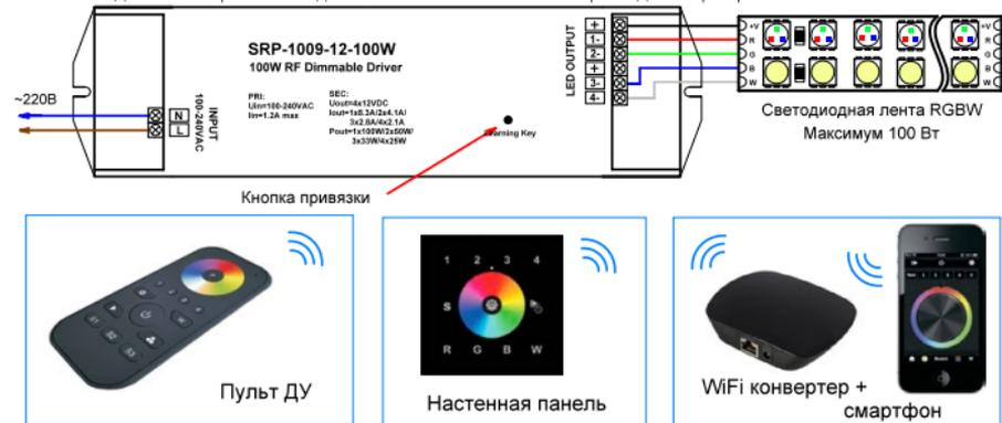
Рис.1. Подключение контроллера при использовании RGBW светодиодной ленты.
