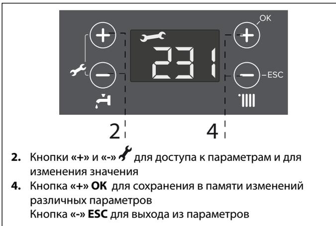
Информация, относящаяся к выбранному параметру отображается на дисплее с помощью цифр.
