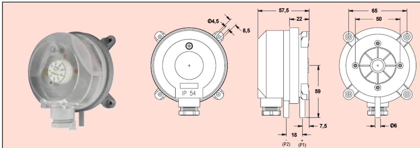
Настраиваемое реле дифференциального давления серии **ADPS** сконструировано для работы с давлением, вакуумом и дифференциальным давлением. Ручка для настройки шкалы позволяет изменить давление коммутации без использования манометра. Доступна серия ADPS с настройками от 20 Па до 4000 Па. Силиконовая диафрагма и корпус из PA 6.6 делает серию ADPS совершенной для использования с воздухом и другими негорючими газами.
