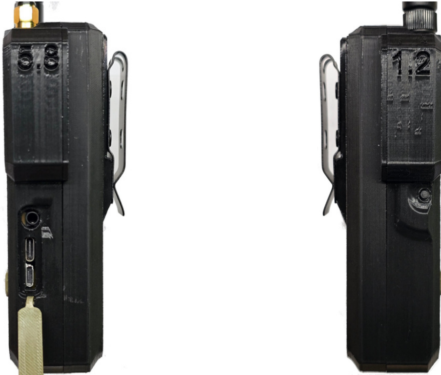
Рис. Позначенням діапазонів, що вказує, до якого роз'єму слід підключати антену відповідного частотного діапазону.
