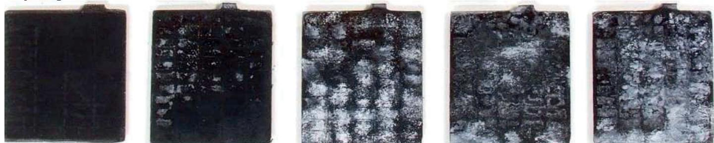
Під час роботи АКБ в циклі Розрядка на пластинах акумулятора утворюється наліт білого або біло коричневого кольору — це кристали сульфату свинцю. Утворення цих кристалів — нормальний процес що виникає під час експлуатації АКБ. Під час розрядки вони утворюються, а під час зарядки — руйнуються\розчиняються... але є багато АЛЕ...
