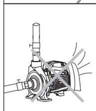
5. Насос должен находиться в вентилируемом помещении, конструкция которого должна предотвращать проникновение атмосферных осадков на корпус и внутрь электродвигателя.
