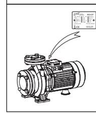
10. Параметры сети питания должны соответствовать значениям параметров, указанных на табличке корпуса электронасоса. При длительном хранении, поместите насос в сухое, вентилируемое и прохладное место при комнатной температуре.
