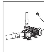
7. Перекачиваемая жидкость может быть горячей и под высоким давлением, прежде чем демонтировать насос, клапаны на обеих сторонах трубопровода должны быть перекрыты, чтобы избежать ожога.
