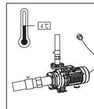
6. В случае падения температуры окружающей среды ниже 4 °С, или в случае длительного простоя насоса, пустая гидросистема может быть повреждена. Не используйте насос при длительном отсутствии воды.
