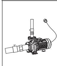
2. Электрический насос должен иметь надежное заземление для предотвращения поражения электрическим током. Для безопасности насос рекомендовано оснастить устройством защитного отключения (УЗО). Не мочить штепсель сетевого шнура.
