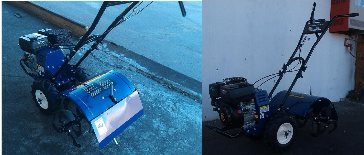
Бензиновый мотоблок с активной фрезой. Предназначен для культивации почвы. Благодаря приводным колесам значительно снижается нагрузка на руки оператора. Увеличенная мощность двигателя (7 л.с.) позволяет культивировать с шириной захвата 700 мм. С помощью сцепки возможно использовать агрегат с плугом, плоскорезами и т. д.
