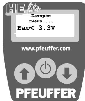
При напряжении ниже 3,3V измерения больше невозможны, прибор HE выключается. Следует поменять батарейки.
