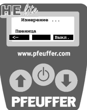
Затем дисплей отображается измеренная доля влажности выбранного продукта. Температура образца корректируется автоматически.
