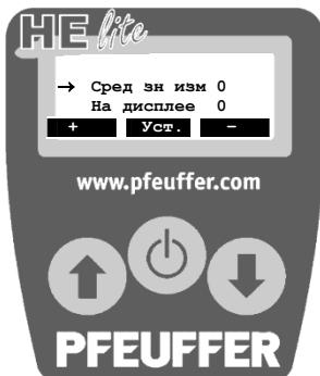
»Сред. зн. изм« является количеством измерений, которые должны быть включены в расчет (можно рассчитывать от 1 до 6 измерений; заводская установка „0“, т.е. расчет среднего значение выключен).
