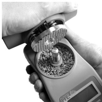
**Чистка** верхней части ячейки для измерения осуществляется с помощью ручной щеточки. Следите за тем, чтобы измельчительный диск при чистке был повернут вниз, чтобы мелкие отходы не попадали в резьбу и не привели к загрязнениям.
