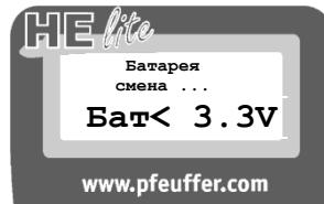
В таком случае старые батарейки необходимо заменить новыми, или же вновь зарядить аккумуляторы. Для этого на задней панели следует открыть панель, за которой находятся батарейки.
