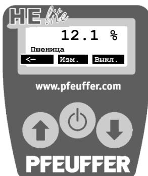
Если измерительная ячейка пуста или образец слишком сухой, на дисплее отобразится величина, которая была превышена или занижена, например, "<9 %" в зависимости от выбранной градуировки.
