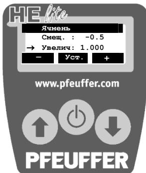
Последствия возрастающих различий при возрастающей влажности может быть исправлено с помощью многофункционального фактора GAIN. Для этого Вам в любом случае потребуются как минимум два образца с по возможности более сильно отличающимися долями влажности, поскольку последствия не могут быть точно определены никаким другим способом.
