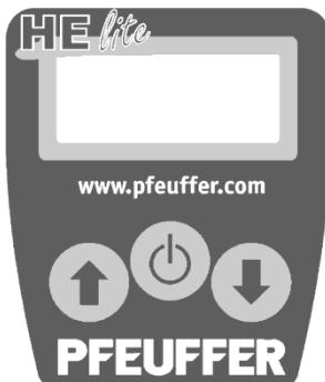
Наполните ячейку для измерения вновь, включите прибор и проведите контрольное измерение с помощью исходного образца.
