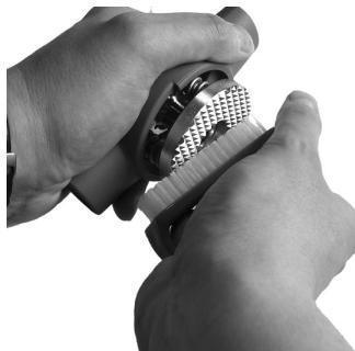
Поворачивая, очистите нижнюю часть и, в зависимости от влажности и клейкости образца, очистите ее с помощью жесткой или мягкой кисточки.
