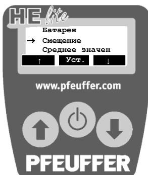
Вновь выберите „Смещение“ и следующие продукт, который следует изменить и т.д. Чтобы выключить прибор, выберите сначала „<----“ с помощью кнопок со стрелками
