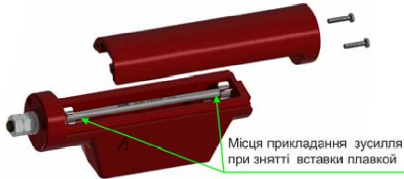
Рисунок 1. Конструкція запобіжника F1x-10/...
