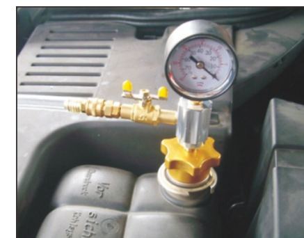
Заправка радиатора охлаждающей жидкостью
