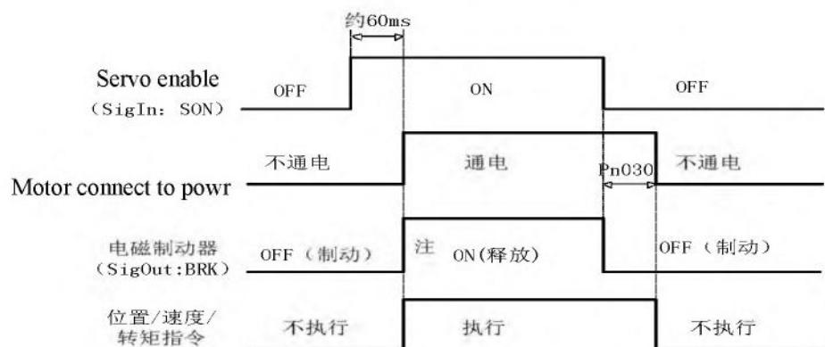
注 1：使用电磁制动功能时，伺服断使能方式 Pn004 必须设置为 2。Note 1: when using electromagnetic brake function, servo broken way can make Pn004 must be set to 2。
