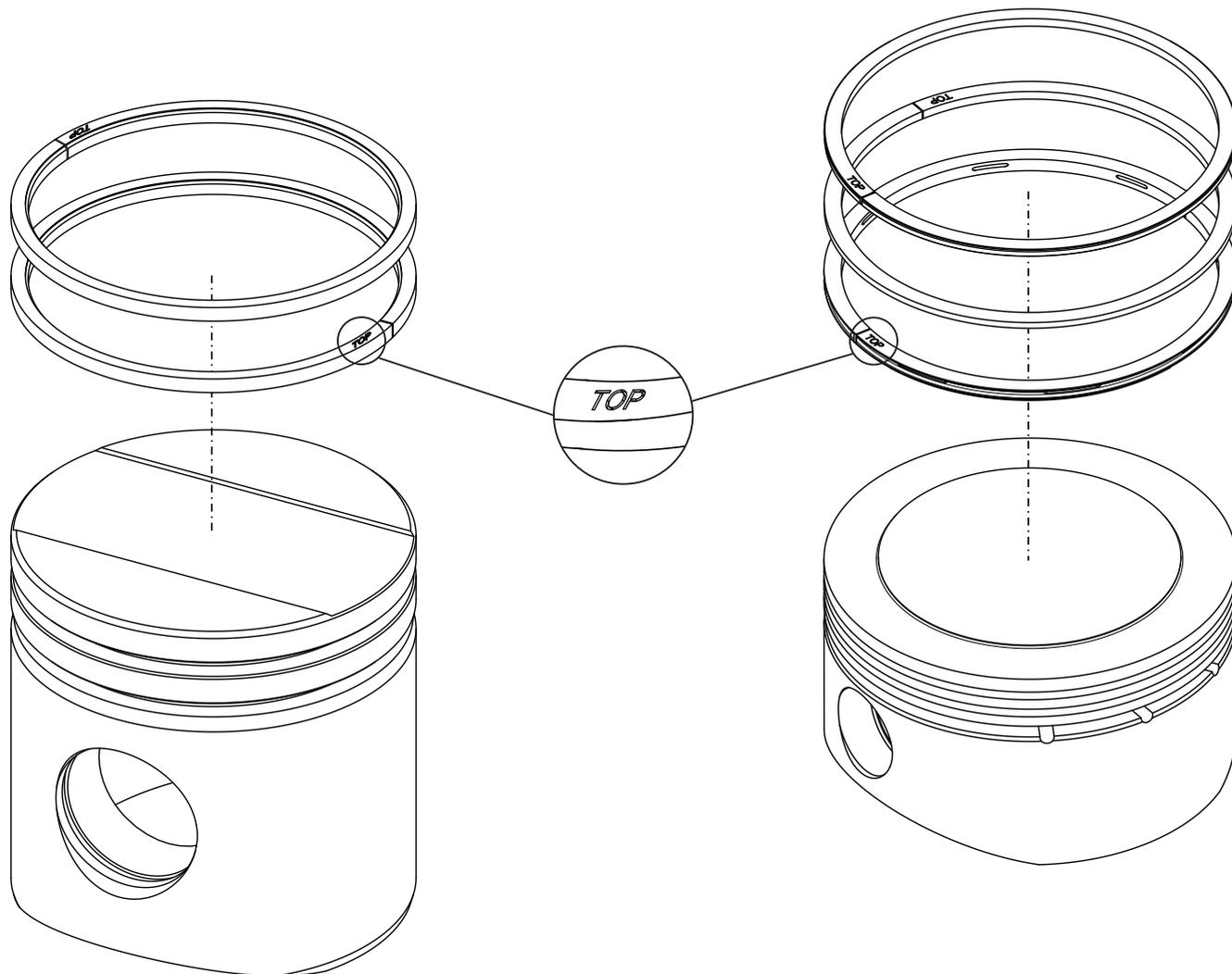
Alternative Kennzeichnung für TOP: farbige Markierung links von der Stoßfuge.
