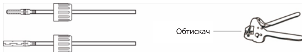
Малюнок 4.10 Обтисніть контактний штифт з дротом
