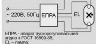
Рис.2. Загальна схема підключення ламп до мережі живлення
