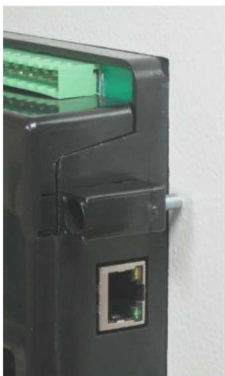
Встановлення гвинтового кронштейна
