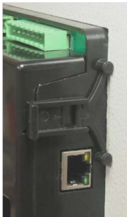
Установка самоудерживающего кронштейна
