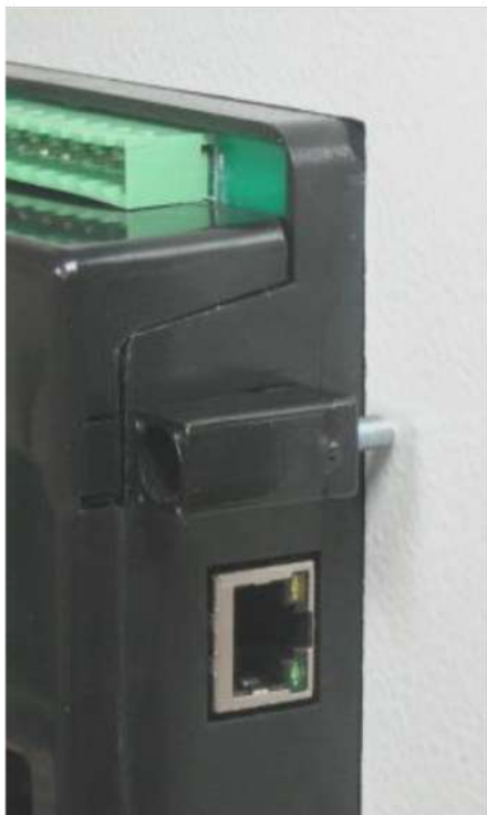
Встановлення гвинтового кронштейна
