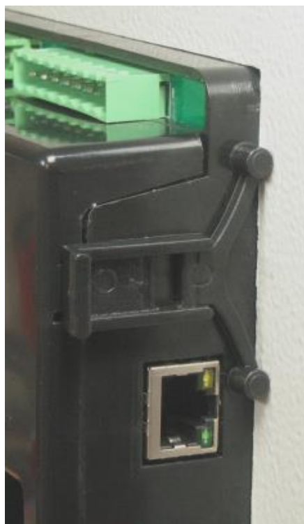
Установка самоутримувального кронштейна
