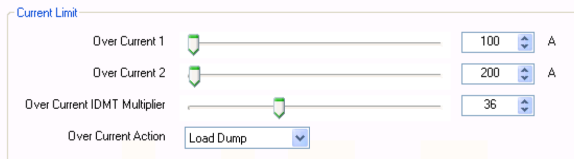
Знімок екрана (скріншот) програми конфігурації RainbowPlus , розділ Generator>Current (генератор > струм)
