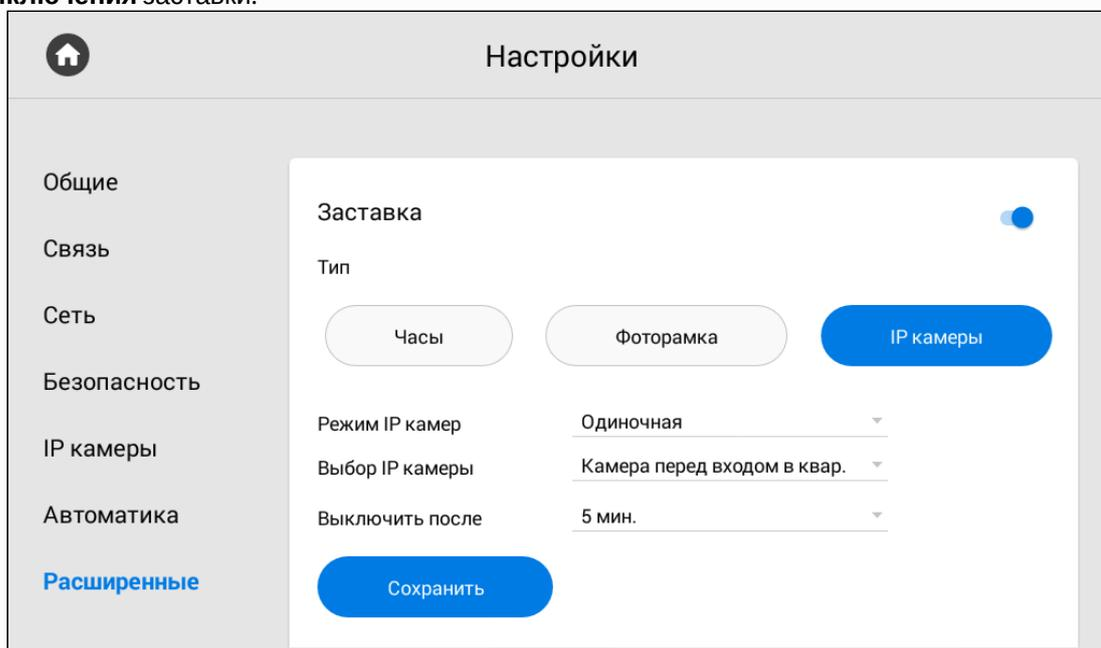
Для режима "**Тур**" выберите необходимые **IP камеры**, которые будут отображаться одна за другой, установите временной **интервал** переключения между камерами и **время выключения** заставки.
