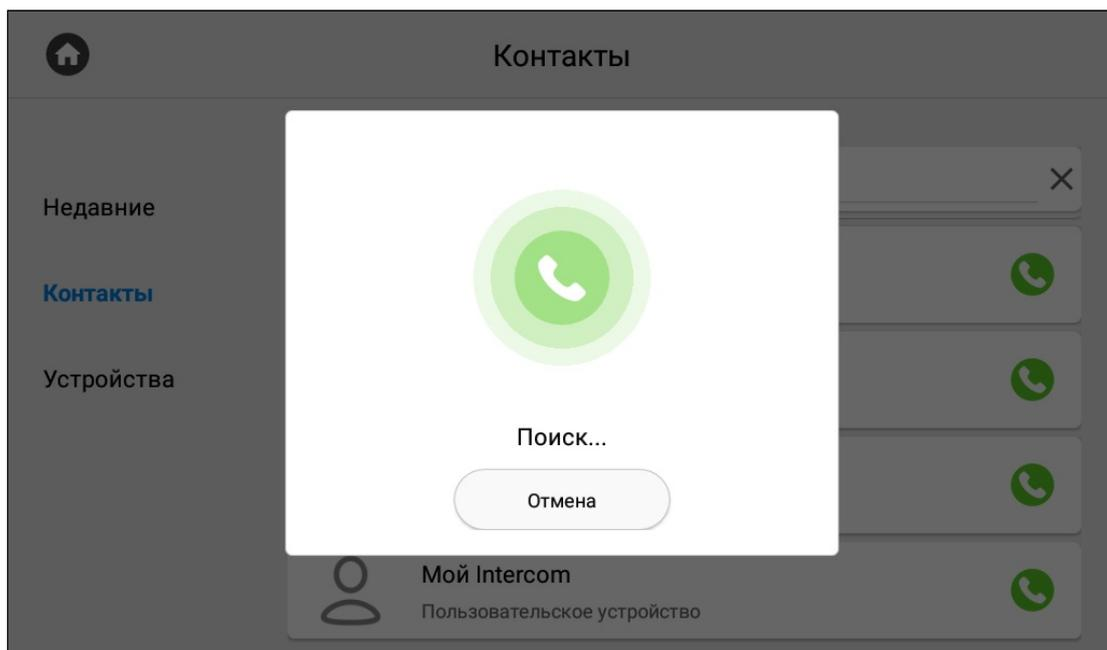
**i** При звонке на вызывную панель будет произведен поиск и подключение к устройству. Панель автоматически принимает вызов на 30 секунд, после чего вызов автоматически завершается.
