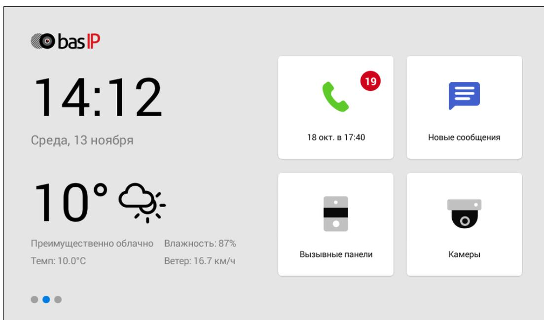
При включении функции "Датчик движения" в правом углу иконки вызовов отображаются пропущенные вызовы, а в левом - уведомления о записанных при срабатывании датчиков движения видео.
