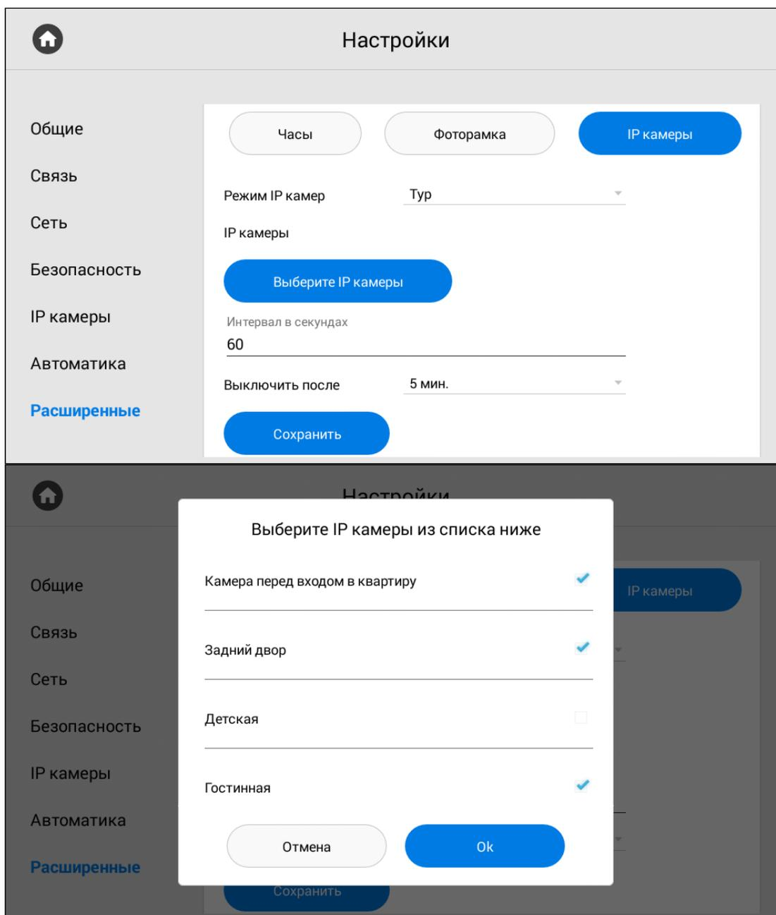
Режим "**Квадратор**" позволяет просматривать изображение с 4-х камер одновременно. Соответственно, в настройках необходимо указать какие **4 камеры** будут транслироваться на монитор и установить **время выключения** заставки.
