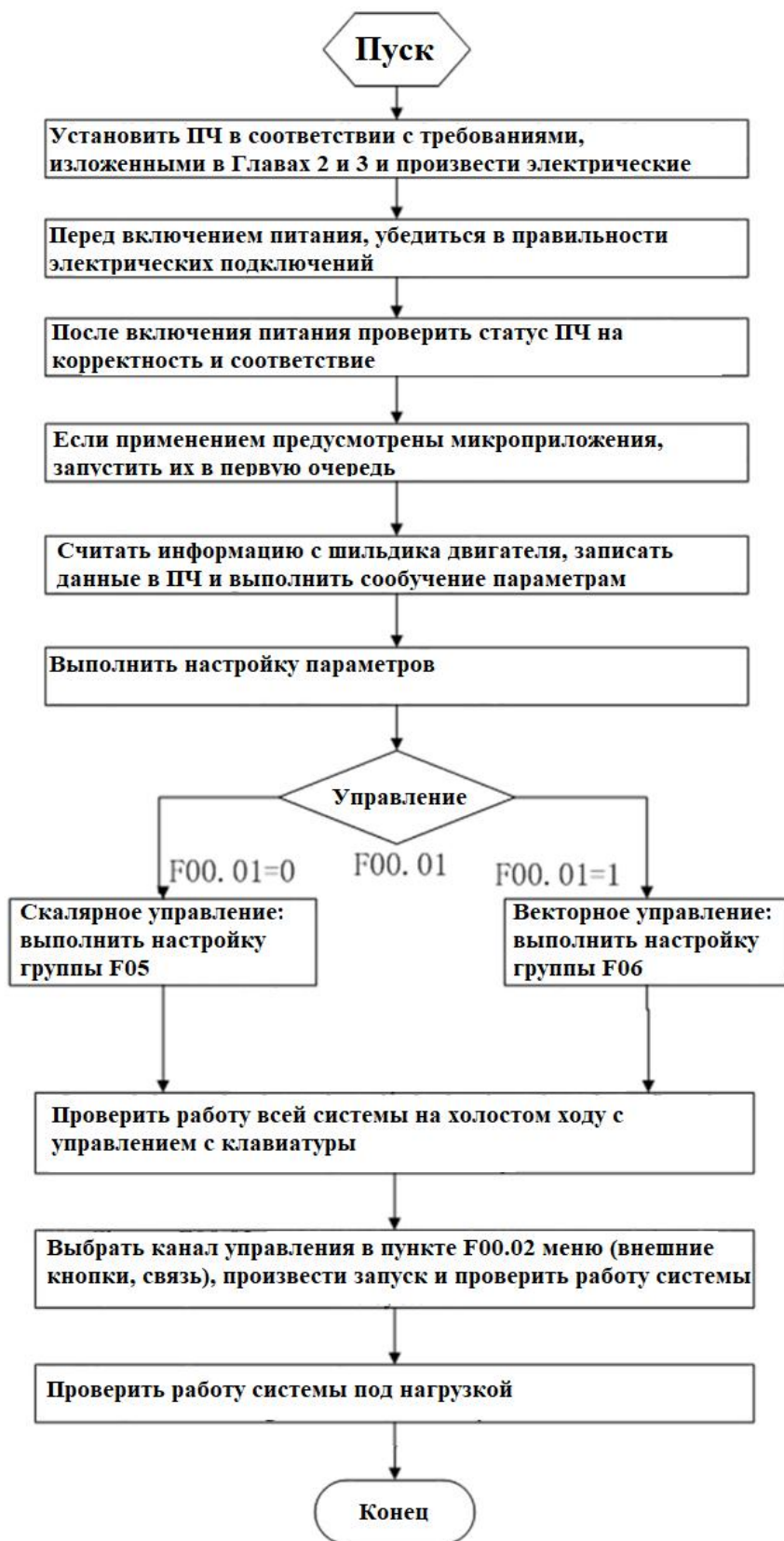
Рис. 5-1 Блок-схема процесса пуско-наладки ПЧ
