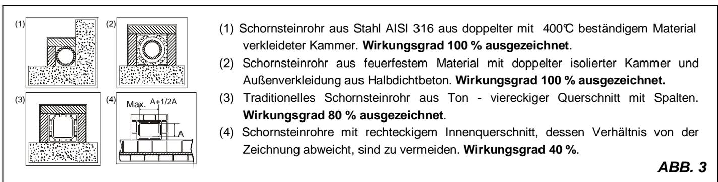
Sollten die Schornsteinrohre einen viereckigen oder rechteckigen Querschnitt aufweisen, müssen die Innenkanten mit einem Radius nicht kleiner als 20 mm abgerundet sein. Was den rechteckigen Querschnitt betrifft, muss das Verhältnis zwischen den Seiten  $\leq 1,5$  sein.
