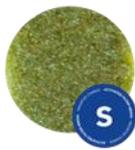
AFM® 0 дает очень тонкую степень фильтрацию, удаляя до 98% частиц до 1µm без коагуляции и/или флокуляции.
