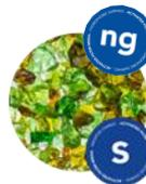
AFM®s 2 используется как поддерживающий слой. AFM®ng 2 - как поддерживающий и фильтрующий слой для удаления частиц до 5 µm
