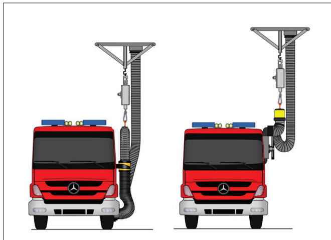
Приклад з насадками, встановленими на вихлопних трубах, розташованих низько або високо
