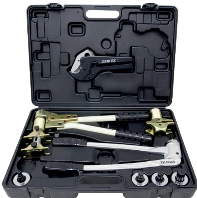
**Комплекти механічного прес-інструменту Raftec** використовується для роботи з трубними системами із зшитого поліетилену PEX. Комплектуючі виконані з нержавіючої сталі. Для з'єднання насувної гільзи потрібно виконати всього 3 кроки. Необхідно відрізати трубу необхідного розміру, надіти на трубу насувну гільзу, розширити трубу за допомогою експандера, вставити фітінг і зробити запресовку за допомогою лещат.
