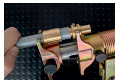
5. Натягнути кільце на трубу за допомогою інструмента для запресування (гідралічний, акумуляторний або ручний прес). Фітинги повинні фіксуватися за фланець, що безпосередньо прилягає до штуцера, на який натягується кільце. Не можна натягувати одночасно два кільця.
