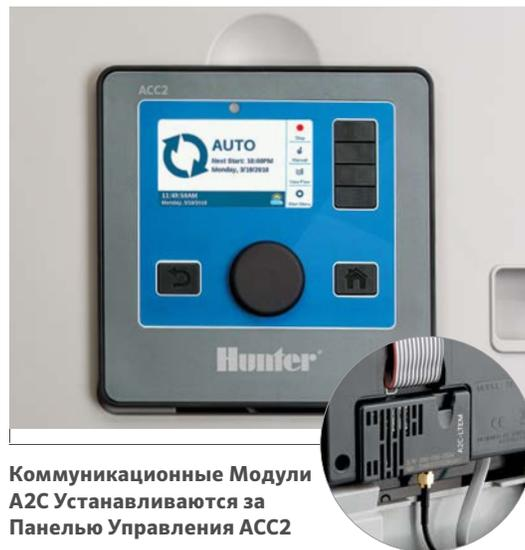
Коммуникационные Модули A2C Устанавливаются за Панелью Управления ACC2
