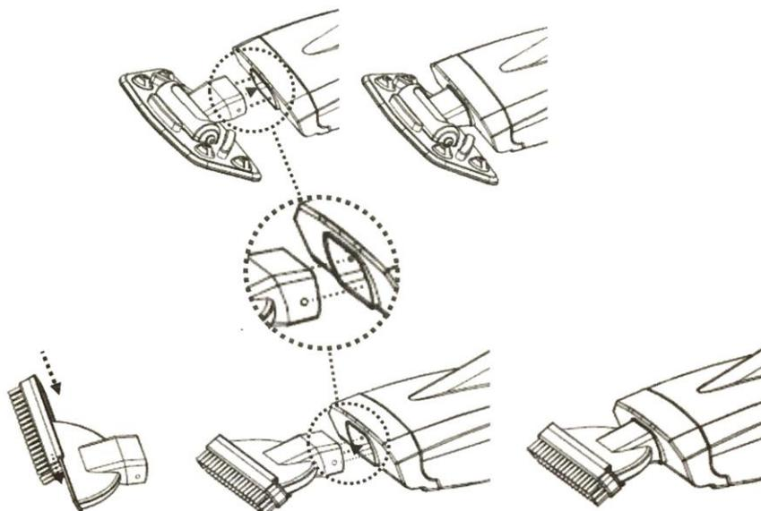
ПРИМЕЧАНИЕ: для замены щетки на всасывающей насадке, поднимите один конец щетки и вытащите ее, чтобы освободить место для новой.
