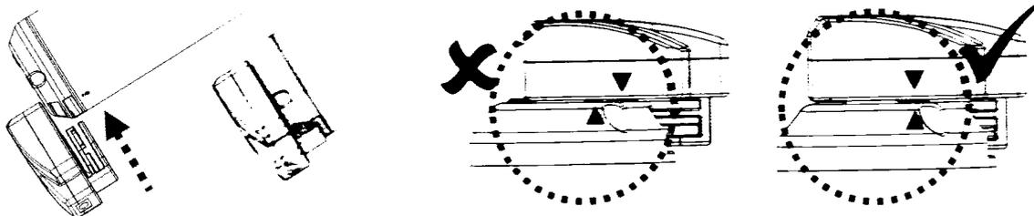
2. Подключите гнездо наружного переходника к зарядному устройству на торце зарядного устройства.
