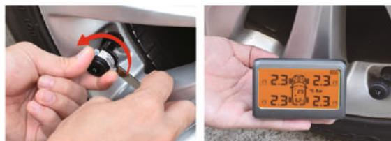
3 Затяните противоугонную гайку 4 Проверьте показания
