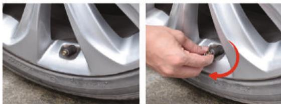
1 Открутить колпачек 2 Затянуть гаечный ключ гаечный ключ
