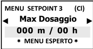
Il **Massimo Dosaggio** è una funzione di sicurezza extra che assicura che il dosaggio sia portato a termine nel tempo selezionato. Questa funzione permette di eliminare limiti di tempo (dosaggio continuo a seconda dei setpoint selezionati) o di selezionare i minuti (fino a 999) e le ore, per esempio dosare per 999 minuti in 24 ore.
