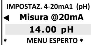
Le uscite analogiche proporzionali a 4-20 mA sono in funzione delle misurazioni in tempo reale in modo da guidare apparecchiature remote come logger dati, PLC o registratori grafici o altre apparecchiature atte a elaborare un segnale mA remoto
