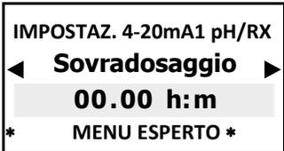
L'allarme del **tempo di sovradosaggio** permette di selezionare un periodo nel quale il set-point deve essere raggiunto. Se in questo lasso di tempo il set-point non è raggiunto, lo strumento blocca le operazioni in uscita, incluse quelle in mA (pompe dosatrici), l'allarme è ON mostrato sul display e attiverà uno strumento di segnalazione connesso al relè di allarme.
