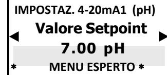
Si ricordi che il valore visualizzato è regolato automaticamente a seconda del **Tipo Misura** selezionato precedentemente
