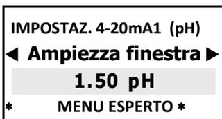
L'ampiezza della finestra imposta la distanza dal punto di impostazione in cui avvierà la modalità 4-20mA: 4mA = 0 impulso della pompa dosatrice, 20mA = frequenza max impulsiva della pompa dosatrice. La larghezza della finestra dipende da molte variabili: punto di iniezione della distanza, tempo di reazione, chimico% ....
