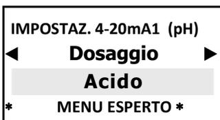
Il setpoint mA è impostato per le operazioni in modo **ACIDO**, l'uscita è attiva quando il valore misurato è più alto del set-point selezionato, la pompa collegata doserà un prodotto acido.
