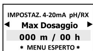
Il Massimo Dosaggio è una funzione di sicurezza che assicura che il dosaggio sia portato a termine nel tempo selezionato. I relè delle pompe dosatrici si apriranno di conseguenza. Questa funzione permette di eliminare limiti di tempo (dosaggio continuo a seconda dei setpoint selezionati) o di selezionare i minuti (fino a 999) e le ore, per esempio dosare per 999 minuti in 24 ore.
