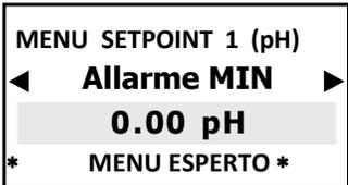
La funzione Allarme MIN seleziona un livello di allarme **MINIMO** passato il quale il relè di allarme si attiva.
