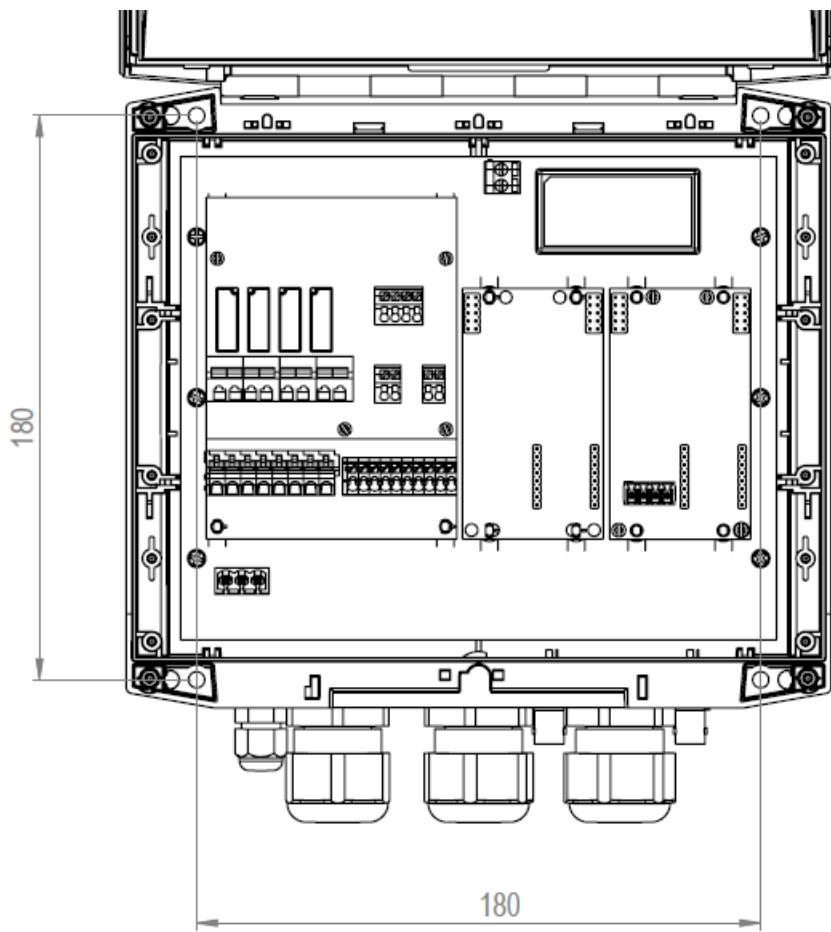
Fig. 2 - Misure per il fissaggio a muro 229l x 204h
