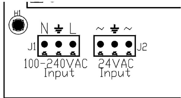
Fig. 1 – Collegamento elettrico
