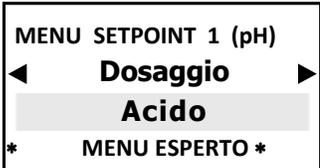
Il setpoint 1 è impostato per le operazioni in modo **ACIDO**, l'uscita è attiva quando il valore misurato è più alto del set-point selezionato, la pompa collegata doserà un prodotto acido.
