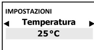
Compensazione di temperatura manuale 0÷100°C.
