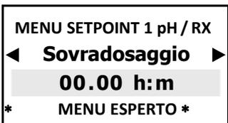
L'allarme del **tempo di sovradosaggio** permette di selezionare un periodo nel quale il set-point deve essere raggiunto. Se in questo lasso di tempo il set-point non è raggiunto, lo strumento blocca le operazioni in uscita, incluse quelle in mA (pompe dosatrici), l'allarme è ON mostrato sul display e attiverà uno strumento di segnalazione se connesso al relè di allarme.
