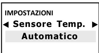
☞ Selezionando compensazione AUTOMATICA per misurazioni e compensazioni di temperatura con sensore PT100.
