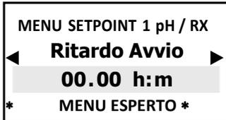
Il **ritardo di avvio** ferma il relè in uscita quando si accende l'unità permettendo così al sensore di polarizzarsi assicurando delle misure affidabili (programmabile).
