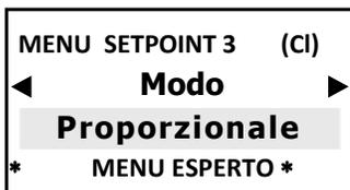
\*Gli impulsi modulari, conosciuti anche come PWM "pulse width modulation", permettono una modalità proporzionale su ogni setpoint ON-OFF attivando gli impulsi corrispondenti sui relè di uscita in base al valore misurato e sempre in relazione alle impostazioni precedenti selezionate. Il punto di attivazione di default è **0,050 ppm** (2 Cl ppm); **0,50 ppm** (range 20 Cl ppm, 20 Cl ppm (Totale), 0-10ppm Cella CLC)
