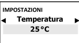
Compensazione di temperatura manuale 0÷100°C.
