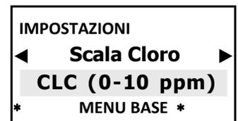
**IMPORTANTE:** una volta selezionata la **SCALA CLORO**, **ASSICURARSI** di connettere il sensore di cloro **adeguato**.
