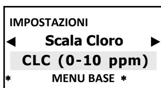
**IMPORTANTE:** una volta selezionata la **SCALA CLORO**, **ASSICURARSI** di connettere il sensore di cloro **adeguato**.
