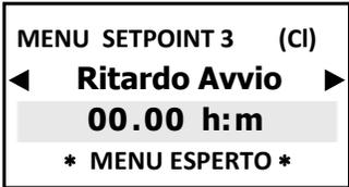
Il **ritardo di avvio** ferma il relè in uscita quando si accende l'unità permettendo così al sensore di polarizzarsi assicurando delle misure corrette (programmabile).
