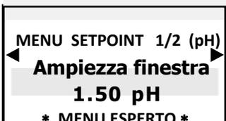
**Ampiezza finestra:** gli impulsi sono temporizzati ON e OFF in base alla distanza dal set-point selezionato, programmabile, esempio: se il set-point selezionato è 7.00 pH e il valore misurato è 9.00 pH, la modalità **PWM** inizierà dopo aver raggiunto 8.50 pH con impulsi Time/Pause e decrescendo il tempo attivo mentre si raggiunge il valore del set-point.
