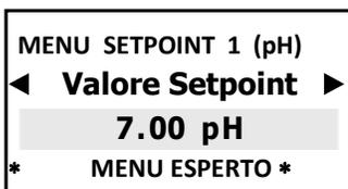
Il setpoint attiverà i relè di uscita per le pompe dosatrici o per altri apparecchi fino a quando verrà raggiunto il valore di setpoint.
