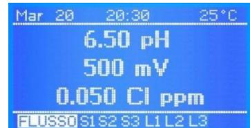
Quando lo strumento viene **acceso per la prima volta**, verrà visualizzato una lista delle funzioni di tutti i tasti. Tale schermata non comparirà più durante le prossime operazioni di avvio.
