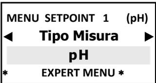
Il parametro di misura PH può essere cambiato in RX con una semplice programmazione e utilizzando l'elettrodo RX
