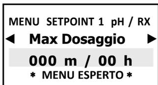
Il **Max Dosaggio** è una funzione di sicurezza extra che assicura che il dosaggio sia portato a termine nel tempo selezionato. Questa funzione permette di eliminare limiti di tempo (dosaggio continuo a seconda dei setpoint selezionati) o di selezionare i minuti (fino a 999) e le ore, per esempio dosare per 999 minuti in 24 ore.
