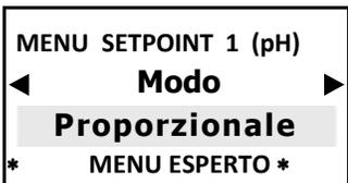
Gli impulsi modulari, conosciuti anche come PWM "pulse width modulation", permettono una modalità proporzionale su ogni setpoint ON-OFF attivando gli impulsi corrispondenti sui relè di uscita in base al valore misurato. Usando il Menu Esperto si devono programmare altri parametri.
