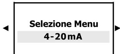
L'uscita analogica proporzionale 4-20mA dell'Eligere CD segue l'opzione precedentemente selezionata nel range di misurazione della conducibilità.
