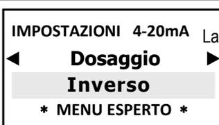
La modalità Dosaggio Diretto significa che l'uscita è attiva quando il valore misurato è inferiore al set-point selezionato, la pompa di dosaggio collegata doserà il cloro e viceversa con la modalità inverso
