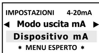
Il Setpoint di dosaggio delle uscite analogiche proporzionali 4-20mA segue il set point selezionato di seguito e attiva quindi una pompa di dosaggio idonea all'elaborazione del segnale in corrente remoto mA.
