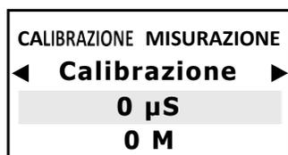
Immergere la sonda CE nella soluzione tampone avente un valore entro il range K del sensore e attendere la stabilizzazione della misurazione.
