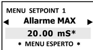
La funzione Allarme MIN seleziona il livello MINIMO superato il quale il relè di allarme è attivo.
