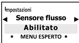
Il sensore di flusso viene attivato in assenza di acqua all'interno del supporto della cella del sensore (l'interruttore di prossimità disattiva tutte le uscite impedendo l'aggiunta di sostanze chimiche extra).
