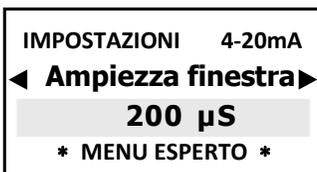
Ampiezza finestra: imposta la distanza dal set point al punto in cui viene attivata la modalità 4-20mA: 4 mA = 0 impulso pompa di dosaggio, 20 mA = max frequenza degli impulsi della pompa di dosaggio. La larghezza della finestra dipende da molte variabili: distanza del punto di iniezione, tempo di reazione, % della sostanza chimica, ecc.
