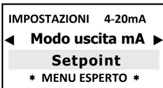
Il Setpoint delle uscite analogiche proporzionali 4-20mA segue il set point selezionato di seguito e attiva quindi un'elettrovalvola o una pompa di dosaggio idonea all'elaborazione del segnale di corrente remoto mA.
