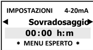
L'allarme di time-out di sovradosaggio seleziona un periodo di tempo per il raggiungimento del set-point. Se il set point non viene raggiunto entro il tempo impostato, il regolatore bloccherà il funzionamento delle uscite, comprese le uscite mA (pompa di dosaggio). L'allarme verrà visualizzato come ON sul display e attiverà il relè4 attivando un dispositivo di allarme.
