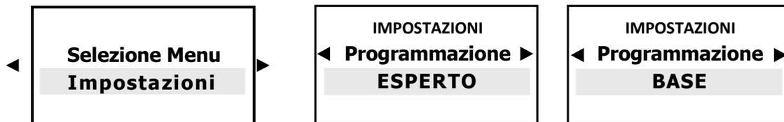
☛ Premere ESC per tornare al MENU PRINCIPALE o premere ESC ESC per visualizzare la MISURAZIONE CONTINUA.
