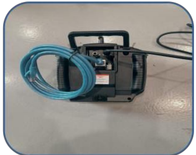
Покращений спосіб підключення (через медіа адаптер)
