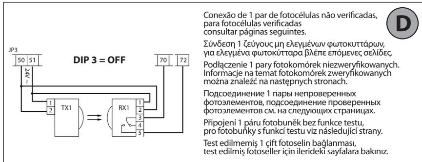
Conexão de 1 par de fotocélulas não verificadas,
