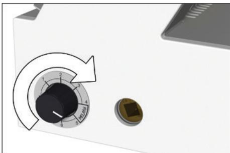
Для уменьшения температуры термосваривания поверните поворотную ручку против часовой стрелки. Для увеличения температуры термосваривания поверните поворотную ручку по часовой стрелке.
