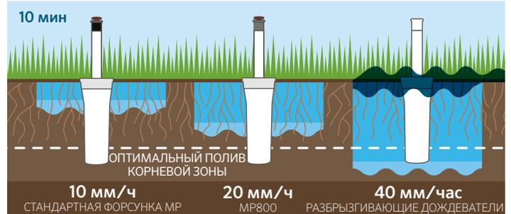
Обязательно учитывайте интенсивность полива при выборе количества запусков системы. Стандартные форсунки MP Rotator медленно подают воду с интенсивностью 10 мм/ч, обеспечивая эффективное орошение даже на плотных грунтах и крутых склонах. Форсунки MP800 подают воду с интенсивностью 20 мм/ч. Они предназначены для грунтов средней плотности и пологих склонов. Скорость подачи воды традиционных дождевателей превышает скорость ее впитывания почвой, что приводит к образованию луж и стеканию жидкости.
