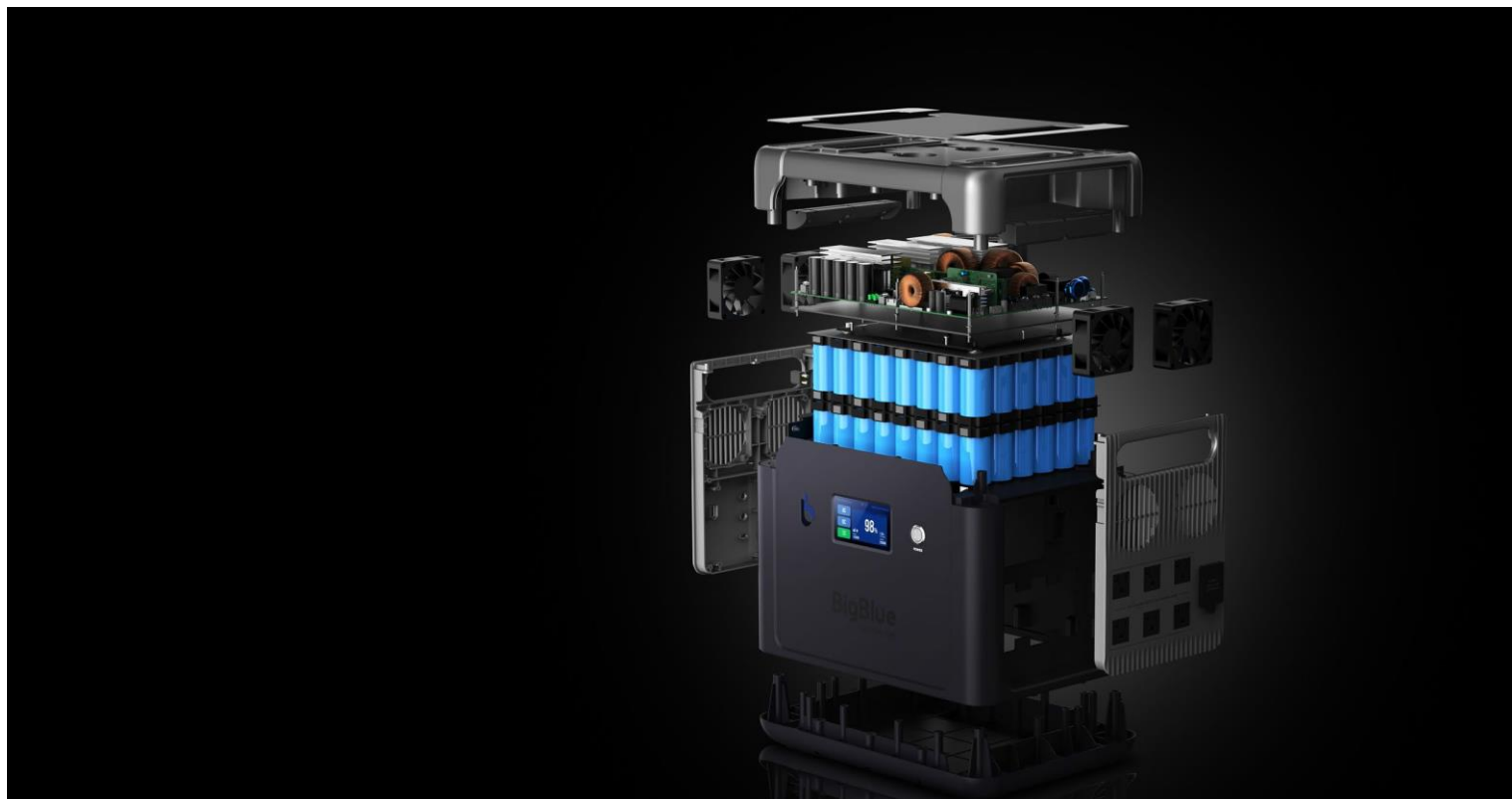
Розгорнута технічна схема портативної електростанції BigBlue CellPowa 2500
