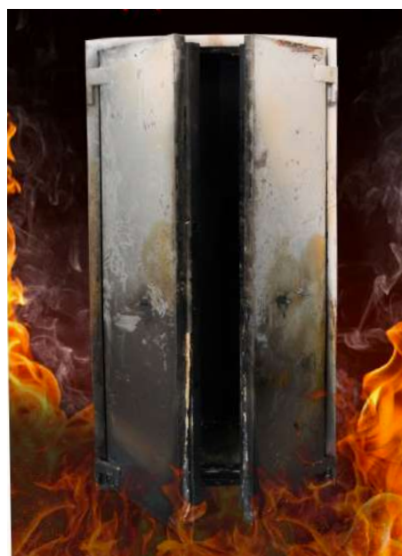
Реальний сейф Griffon FSL195.2 після випробувань на вогнестійкість
