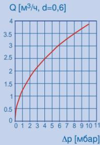
Регулируемый расход газа Q (15 °C, 1013,25 мбар) как функция выходного давления p<sub>2</sub> при настройке кнопки управления на поз.7 и холодном термочувствительном элементе в соответствии с EN 88.
