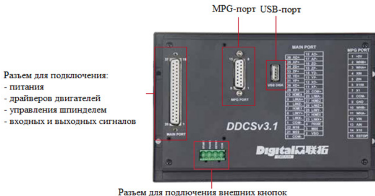
Рис. 2.1.1 Разъемы и порты контроллера
