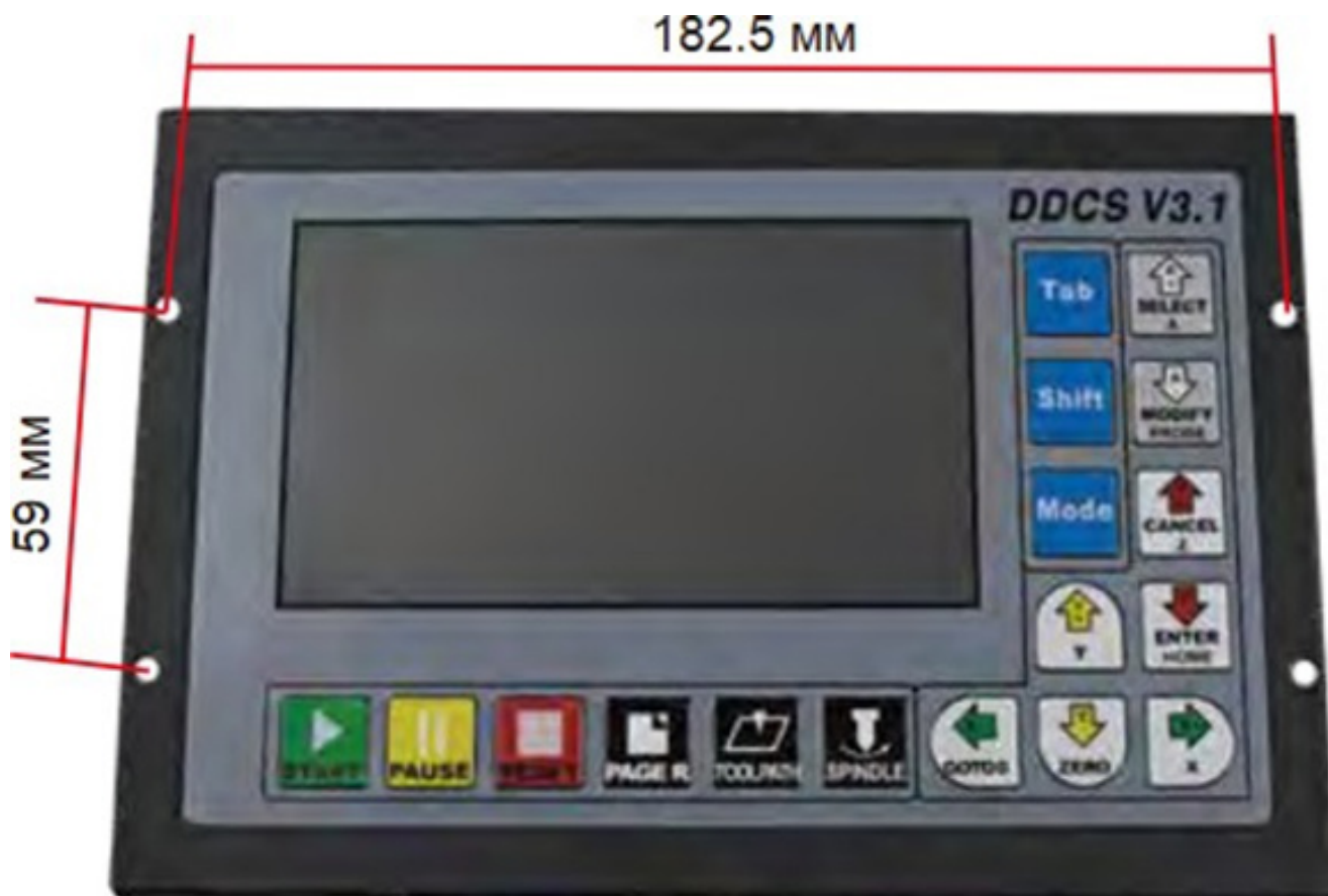
Рис.1.2.1 Вид спереди и размеры монтажных отверстий
